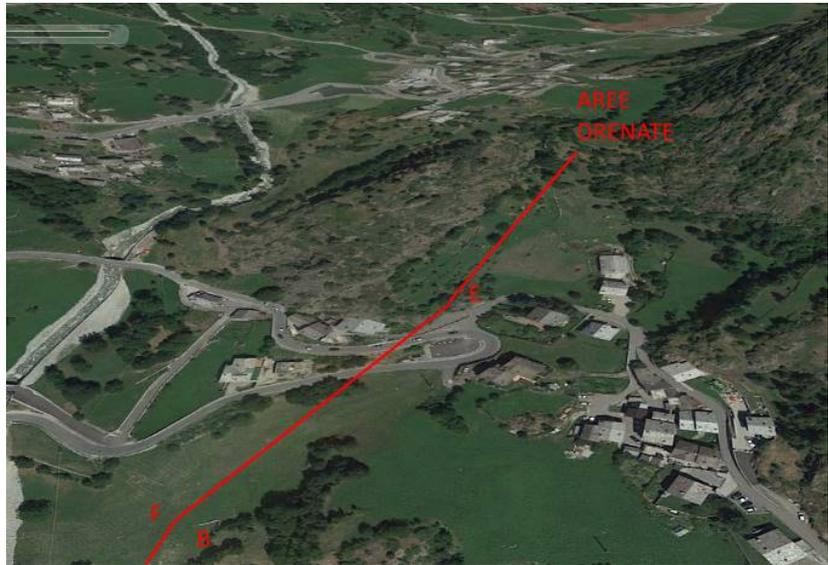
Attraverso una specifica derivazione (punto F) è possibile, utilizzando la condotta di cui al punto precedente, convogliare anche questa portata d'acqua all'interno della vasca dell'opera di presa (A).
